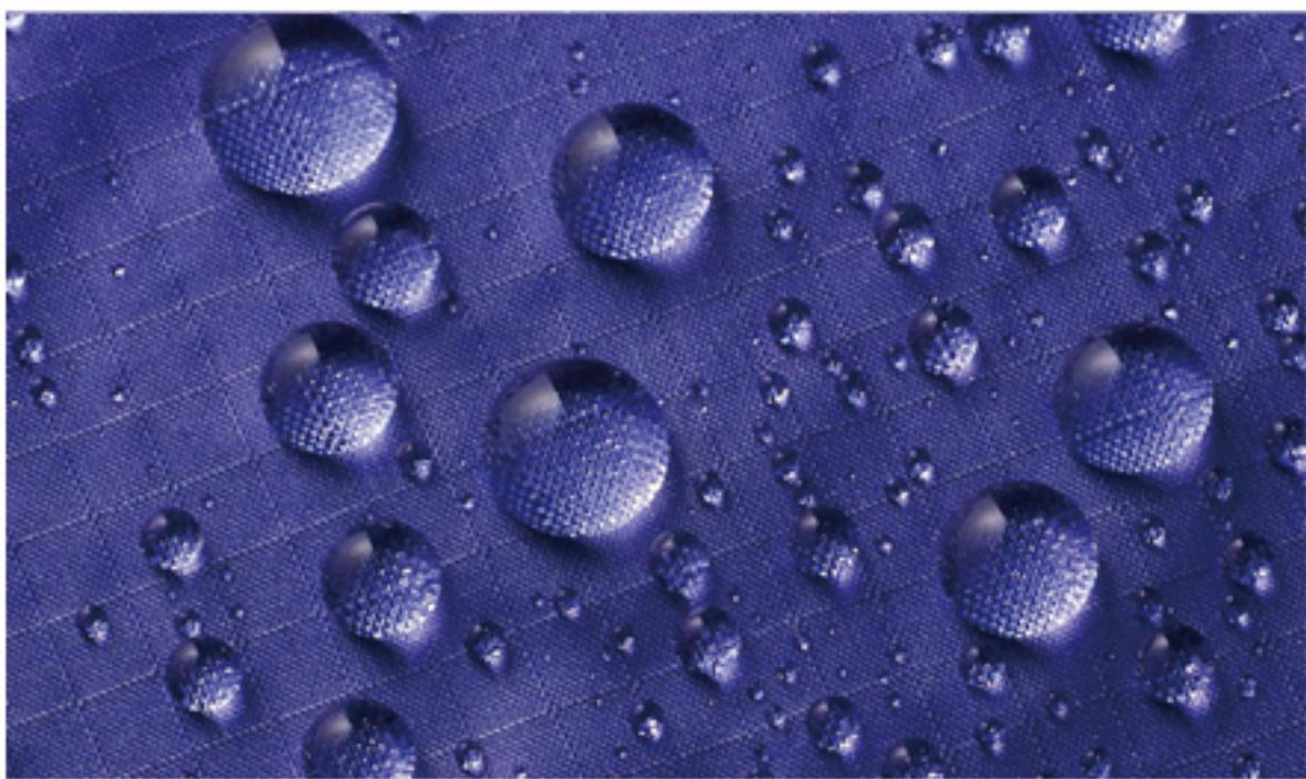
エアモデルのアウターシェルには「ナイロン66」を採用。超撥水性能、優れた引き裂き強度・耐摩耗性・耐熱性を持ち軽量性と長期間のご愛用には欠かせない素材です。
